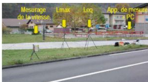
Figure 21 : Méthode statistique au passage (ISO 11819 - 1).
