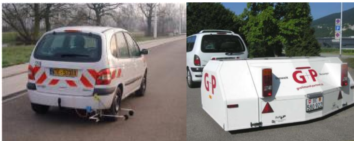
Figure 23 : Exemples de mesure de bruit de roulement en continu.
