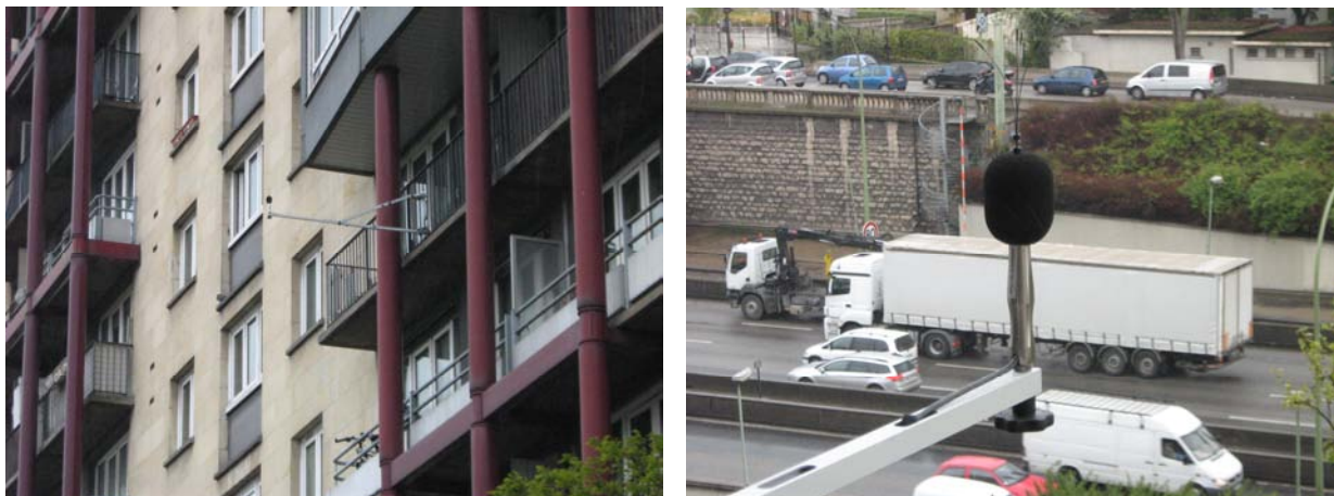
Figure 27 : Station de mesure du bruit en façade de l'immeuble l'Herminier.
